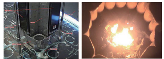
図3 原子炉芯構造物とコールドクルーシブルによる燃料系デブリ模擬溶融試験
