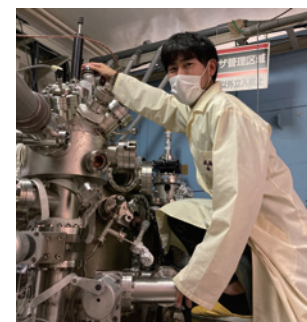
図 1 高エネルギー加速器研究機構フォトンファクトリー BL27A の XPS チャンバー
