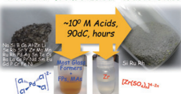
図 3 将来的核変換のための放射性廃棄物ガラス固化体湿式処理技術開発。
