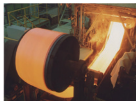
図2 スクラップ鉄からのストリップキャスティングによる薄板創製
