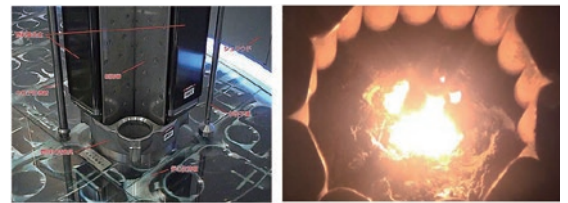
図3 原子炉芯構造物とコールドクレーシブルによる燃料系デブリ模擬溶融試験
