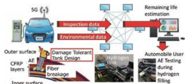
図 1 損傷監視システムを用いた燃料電池自動車水素貯蔵容器の健全性保証システム
