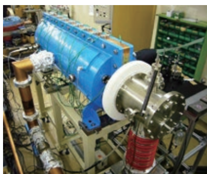
図1 2ビーム型高周波四重極線形加速器の原理実証機
