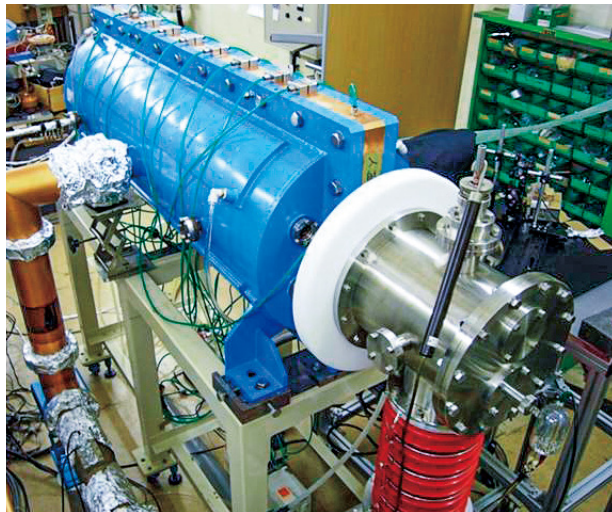
図1 2ビーム型IH-RFQ線形加速器の原理実証機
